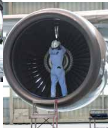
エンジンのファンブレード交換作業風景。すっぽりと人が入ってしまうほどの大きさ。
