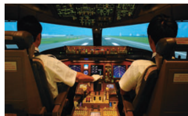
ボーイング767-300型機のシミュレーター
