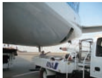
排水作業と排水車
