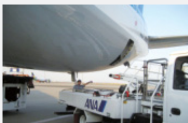
排水作業と排水車
