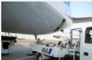
排水作業と排水車
