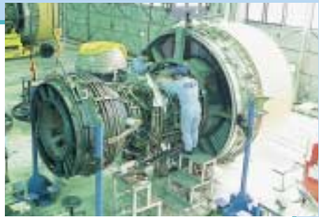
機体から取り降ろされた原動機は分解され、細部まできめ細かくチェックされる。
