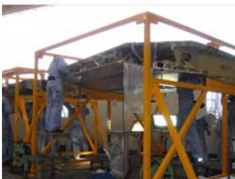
ANA グループ整備部門の訓練用メンテナンス・トレーニング・モックアップと訓練の様子
