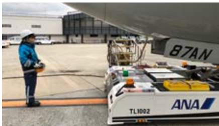
Mototok社製の電動車両によるプッシュバック
