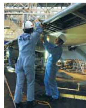
翼の修理作業。どんな小さなきずも見逃さず、丁寧に修理されていく。
